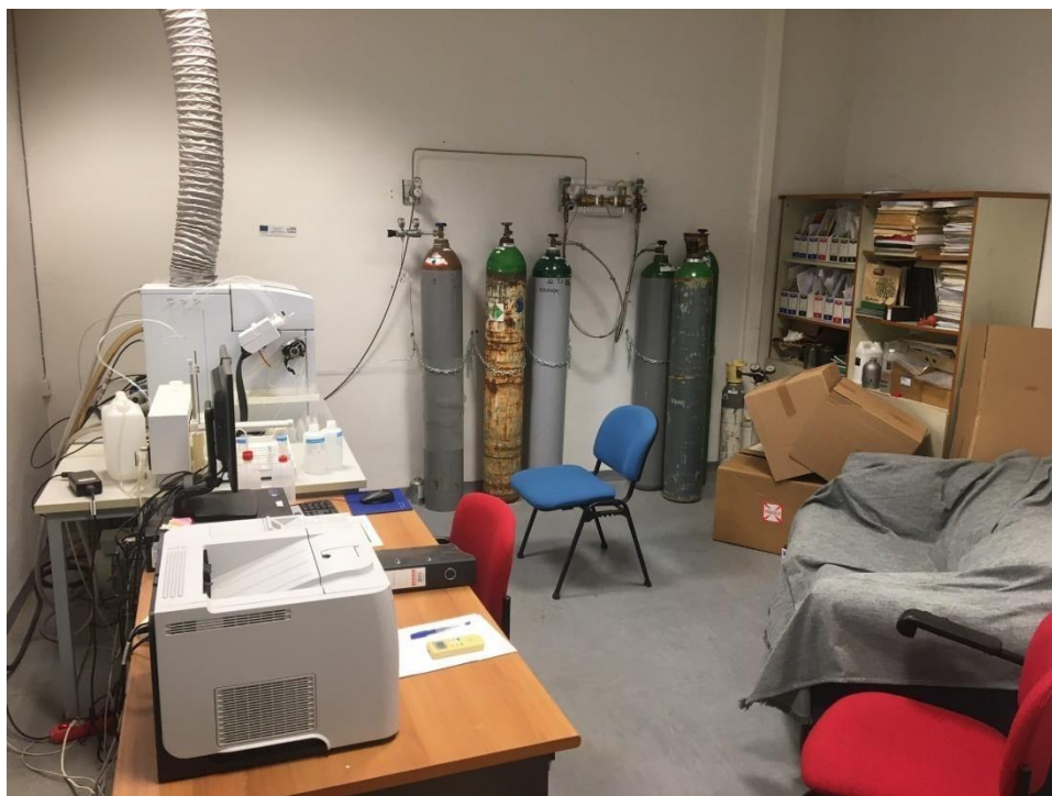
Φώτογραφια 1. Η μοναδα ICP-MS μαζί με τον βοηθητικό εξοπλισμό της στο χώρο της στο κτίριο της Αργύροκαστρου. Απαιτείται αποσύνταξη, ασφαλής μεταφορά και επανασύνταξη όλων των εικονιζομένων στοιχείων.
